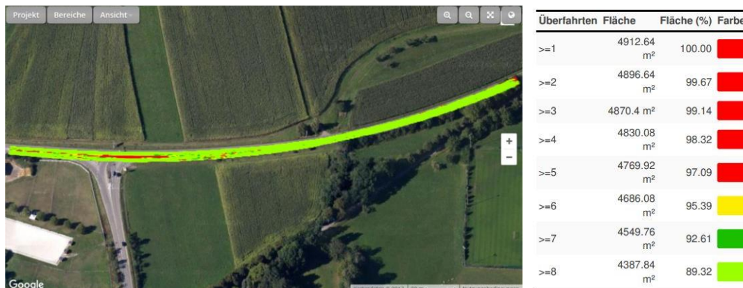
Abbildung 6: Darstellungsbeispiel 2 Anzahl der verdichtungsrelevanten Walzüberfahrten
